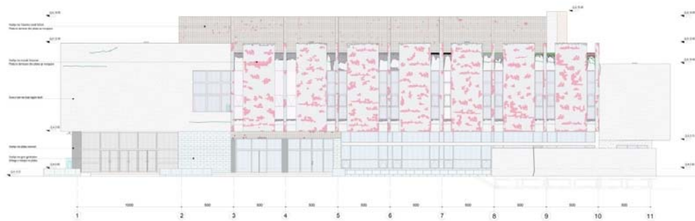
Figura 14. Problematikat e evidentuara ne fasaden perendimore
